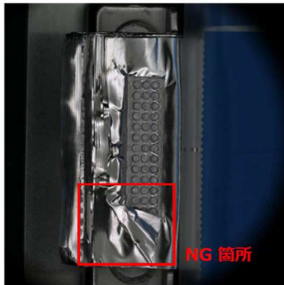
バッテリーセルのラグは溶接後に折り置られます
